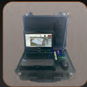
无线监控基站
